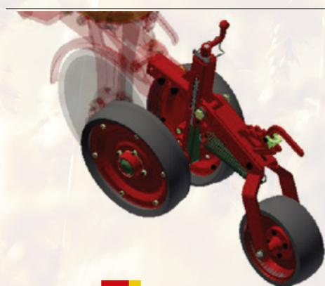
Limitador em "V" independente ou fixo com 3ª roda compactadora.
