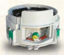
Dosador mecânico de sementes que proporciona ao agricultor um alto percentual de redução de duplos e falhas. Indicado para 8 culturas (algodão, amendoim, canola, feijão, milho, milheto, soja e sorgo) trocando apenas os discos e anéis. É um equipamento simples de ser usado por se tratar de um sistema a disco, com uma manutenção descomplicada.
