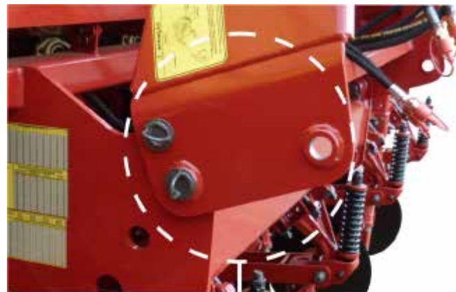
CABEÇALHO SUSPENSO E TRAVADO
